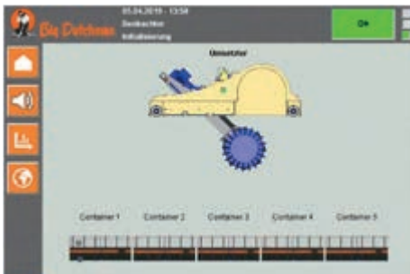
Устройство за разбъркване с моментното (актуално) положение на раздробяващия барабан
