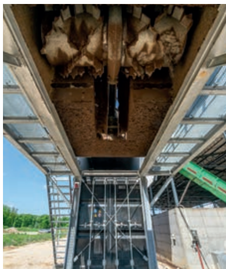
Поглед отдолу към устройството за разбъркване в позиция на покой- лесно за поддръжка
