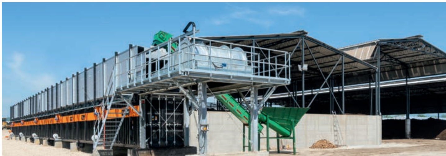
CompoLiner- поглед откъм страната за аериране и изходната позиция на устройството за разбъркване на тора
