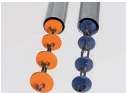
DryRapid-Förderrohr mit Förderketten
