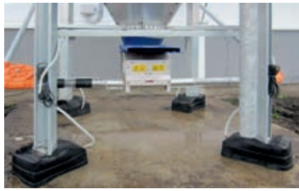
Silofußabdeckung: sicheres Wiegen bei extremen Witterungsbedingungen
