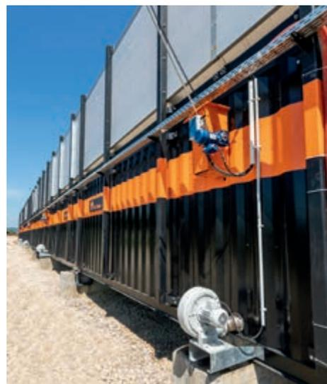
Un compresor conduce aire fresco al material sometido al compostaje
