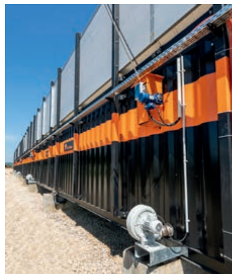
Компрессор подает свежий воздух на участок с компостируемым материалом
