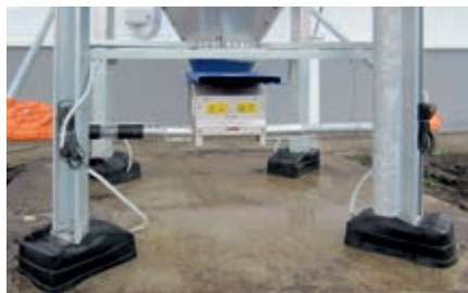
Защитное покрытие для бункерных опор: для надежного взвешивания в экстремальных погодных условиях
