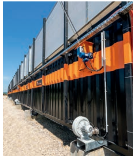
Duvaljka utiskuje svež vazduh u materijal koji se kompostira
