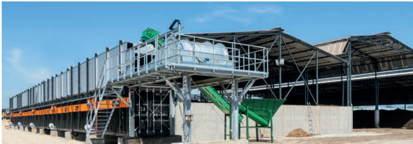
CompoLiner – pogled sa strane punjenja i položaj održavanja trakastog skrepera
