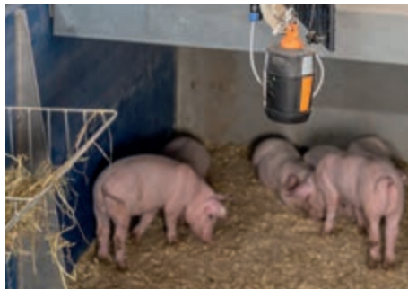
Вимірювання NH 3 у приміщенні (в експериментальних цілях і з окремим дисплеєм)
