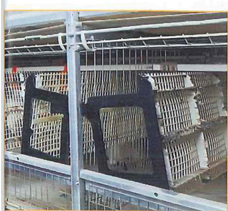
Фото 2. Откидной пол с пластмассовой решеткой гигиеничен и эластичен
