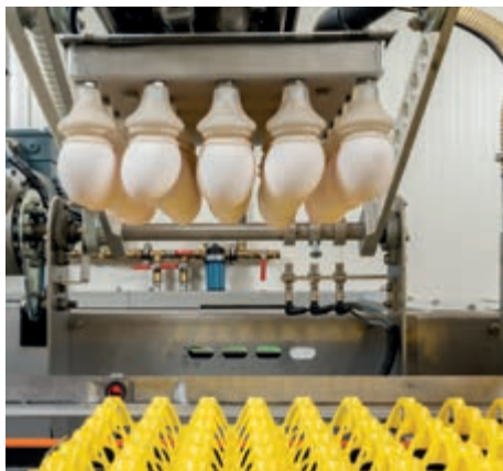
Doppelt geführter Transferarm, waagerechte Stellung des Kopfes während der Eiablage in den Höcker und Druckluft sorgen für eine sehr schonende Eierablage
