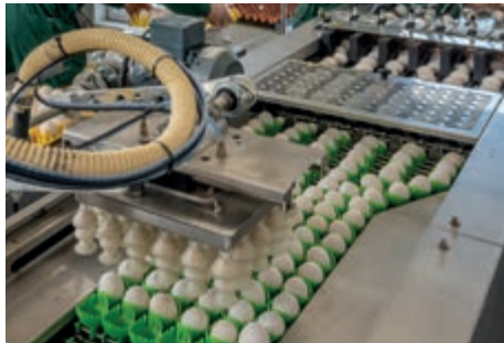
Dosiersystem sorgt für einen kontinuierlichen Eierstrom in den Farmpacker
