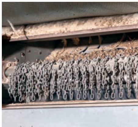
Standardmäßig integrierter Häcksler mit 10 cm langen Kettengliedern
