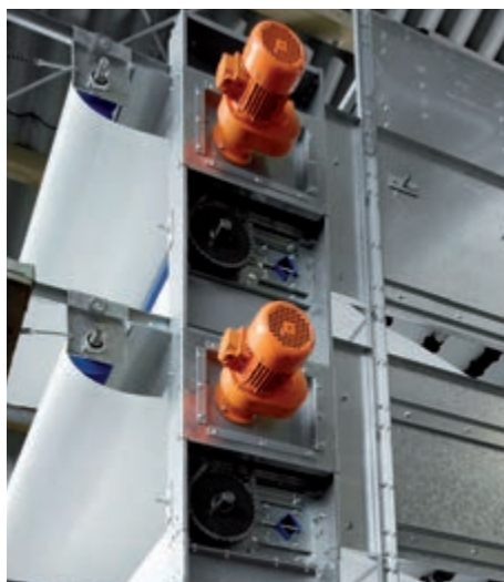
Unidad motriz de la cinta de estiércol estándar e inversión de la rosca sinfín por piso
