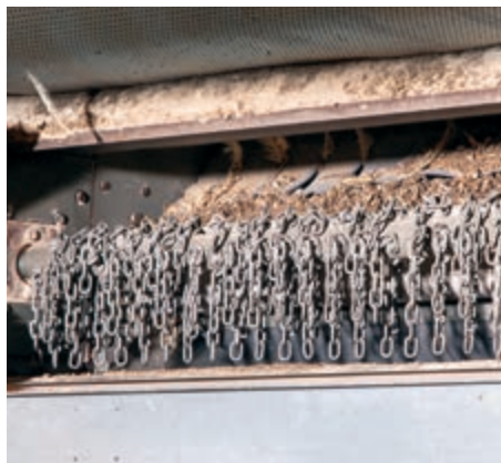
Triturador integrado de forma estándar con eslabones de 10 cm de longitud
