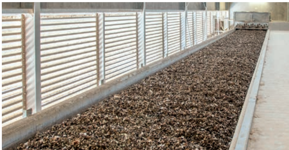
Vista del piso superior, al final se encuentra una escoba de estiércol que afloja la estructura del estiércol
