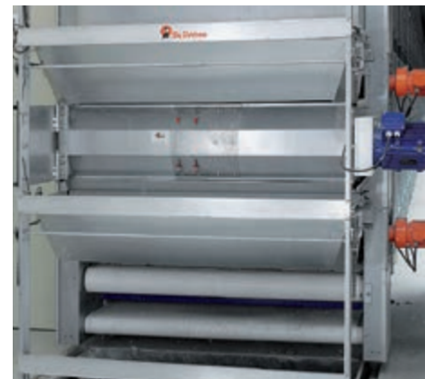
El triturador está montado aquí entre el 3 er y el 4 o piso
