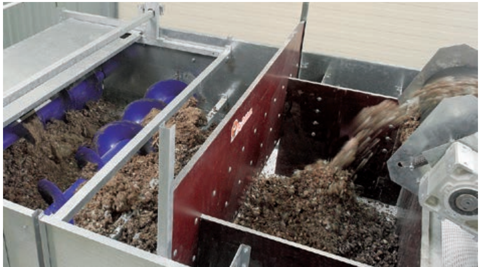
Los sinfines de distribución permiten un llenado uniforme de las cintas
