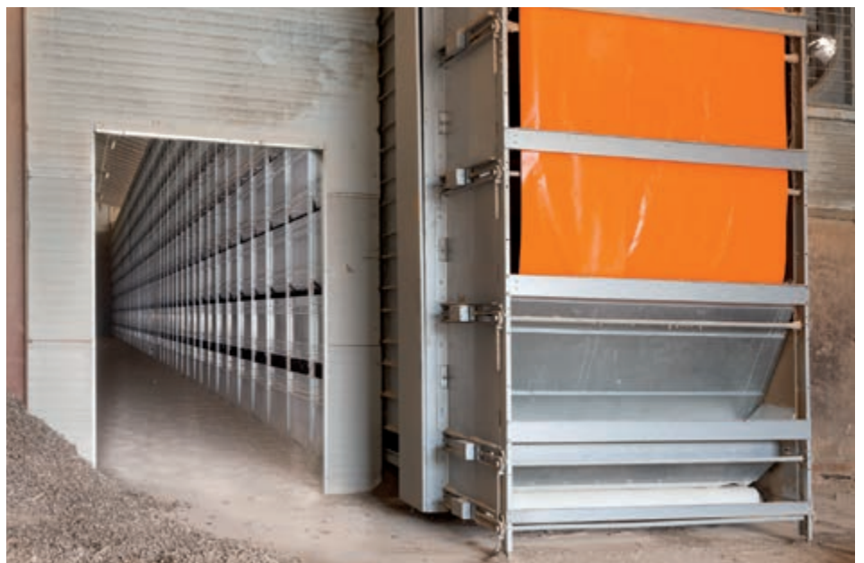
Túnel de secado de estiércol OptiSec con 16 pisos
