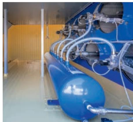
Limpieza de filtros mediante aire a presión
