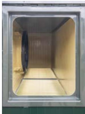
Vista del interior del Earny2 S: El ventilador aspira el aire fresco precalentado hacia el interior de la nave
