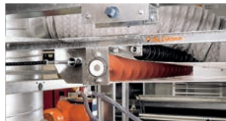
Rodamiento cinta de estiércol con espiral de limpieza (opcional), limpia la cinta de polvo y plumas durante el retorno
