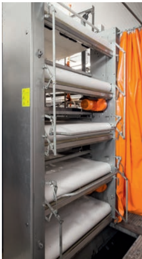
Conjunto final de cinta de estiércol con rascadores y ajuste central
