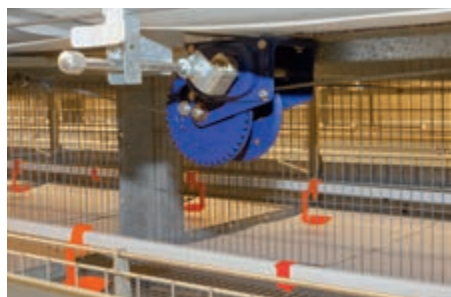
Torno instalado en el centro para el ajuste en altura de la línea de bebederos
