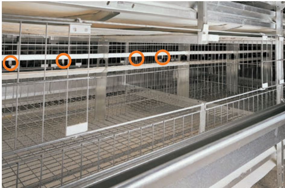
Piso de recría – cuatro tetinas de acero inoxidable abastecen a los animales con agua limpia
