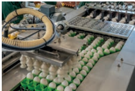
Le système de dosage garantit un flux d'œufs continu dans l'emballeuse
