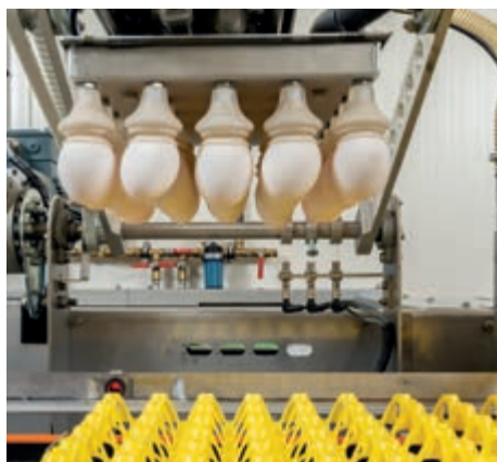
Le bras de transfert à double guidage, la position horizontale de la tête pendant le dépôt des œufs dans l'alvéole et l'air comprimé permettent une manipulation en douceur des œufs
