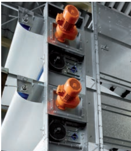
Standardowy napęd taśmy i rozdzielacz ślimakowy na każdym piętrze
