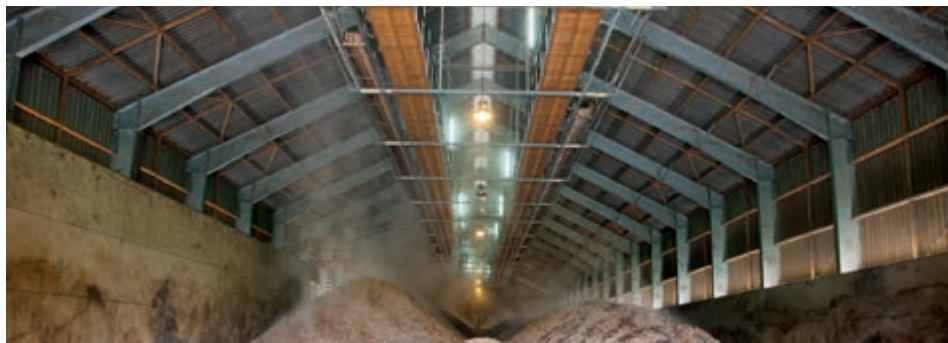
Widok na system rozprowadzania w postaci wzdłużnie przesuwanego systemu przenośników z dwoma przenośnikami taśmowymi
