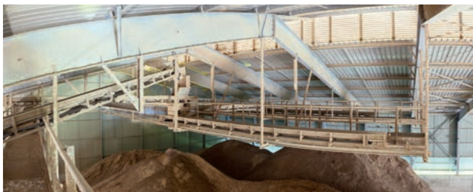
Widok na system rozprowadzania w postaci wzdłużnie przesuwanego systemu przenośników z trzema przenośnikami taśmowymi
