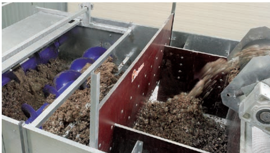
Rozgarniacze ślimakowe zapewniają równomierne rozprowadzanie pomiotu na taśmach
