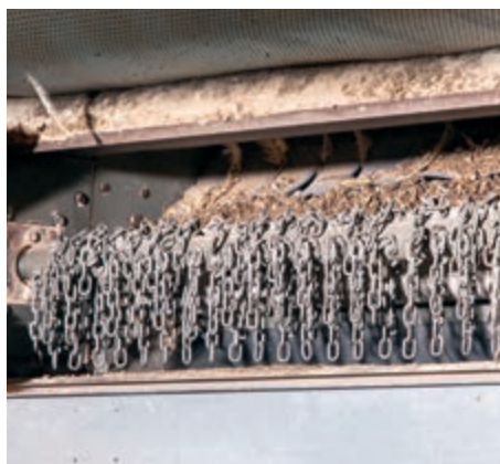
Standardowo zintegrowana rozdrabniarka z ogniwami łańcuchowymi o długości 10 cm
