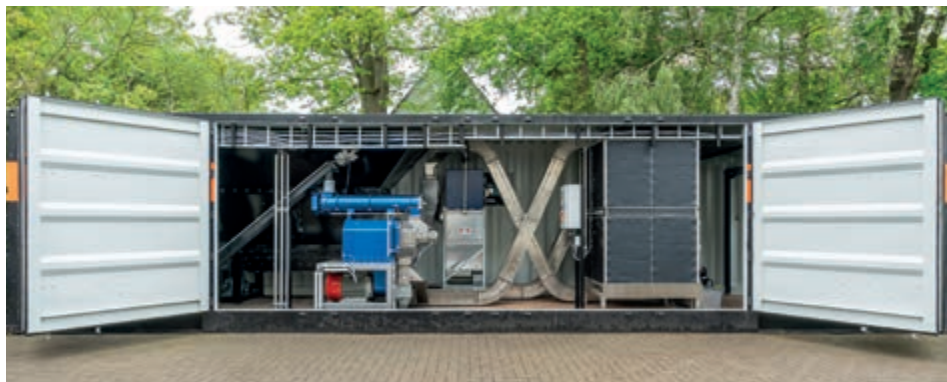
Dostawa gotowego do podłączenia BD PelletBox 750 w 40-stopowym kontenerze HQ (1292 x 2438 x 2896)
