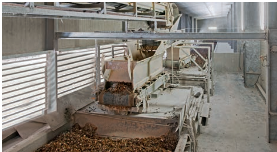
Stanowisko załadunkowe: tutaj obok siebie stoją 2 systemy OptiPlate, które są napelniane przez przenośnik taśmowy
