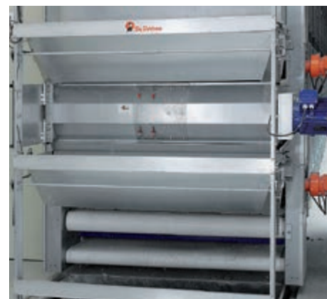
Rozdrabniarka zamontowana w tym przypadku między 3 a 4 piętrem
