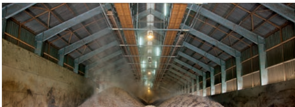
Вид на продольное распределительное устройство с двумя транспортерными лентами
