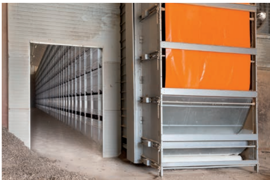
Установка для сушки помета туннельного типа OptiSec с 16 ярусами
