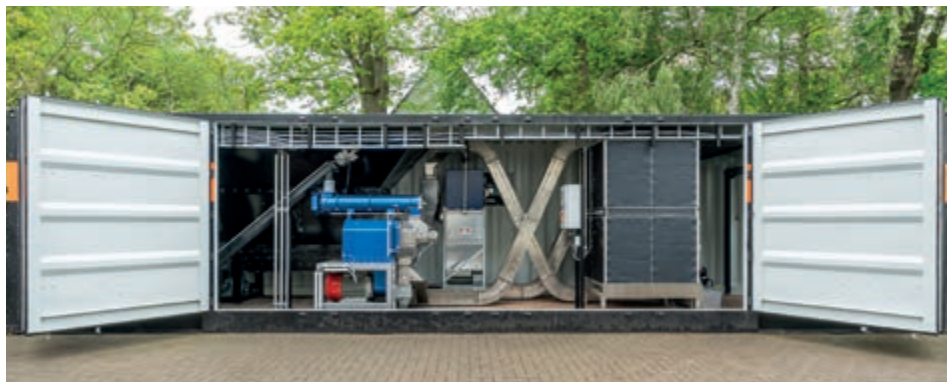
Поставка установки BD PelletBox 750 в готовом для подключения виде в контейнере, изготовленном из высококачественного материала размером 40 футов (12192 x 2438 x 2896 мм)
