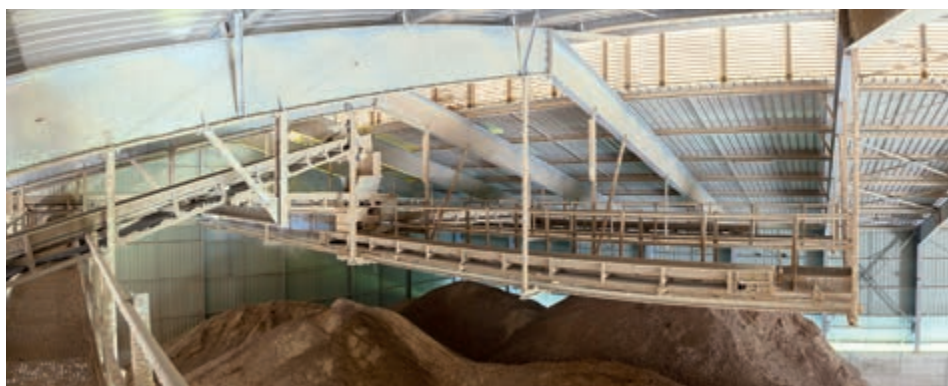
Вид на продольное распределительное устройство с тремя транспортерными лентами
