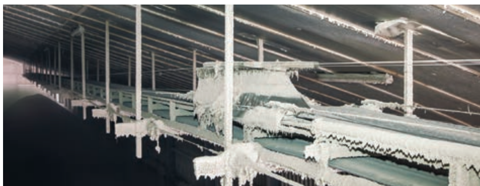
Вид на распределительную ленту с плужным скребком
