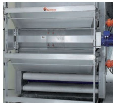
Измельчитель установлен в данном случае между 3-м и 4-м ярусами
