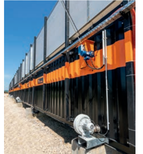
Bir kompresör gübreleştirilecek malzemeye temiz hava basar
