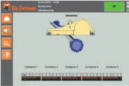
Freze tamburunun mevcut konumu ile şerit çevirici
