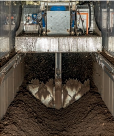
Bir şerit çevirici malzemeyi öğütür ve homojenleştirir
