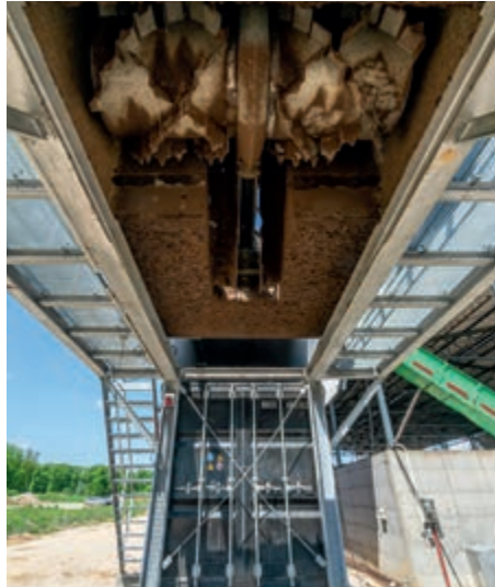
Park konumundaki şerit değiştiricinin aşağıdan görünümü-kolay bakım
