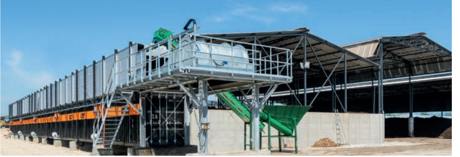
CompoLiner - dolun tarafının görünümü ve şerit çeviricinin bakım konumu
