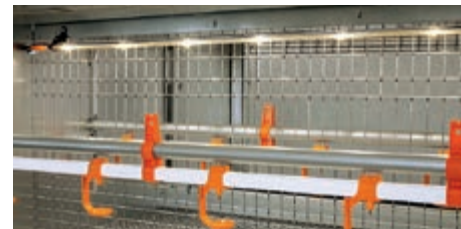
FlexLED за осветление на вторият етаж
