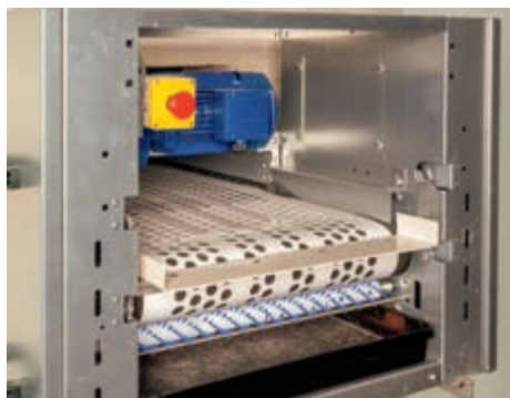
Стандартна задвижваща станция на лентата за яйца
