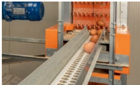
Прехвърляне на яйцата снесени извън гнездата на елеватор
