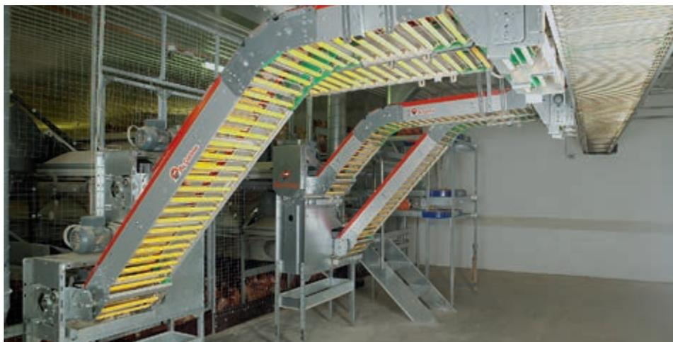
Steilförderer kommen vor allem dann zum Einsatz, wenn es nur wenig Platz zwischen Nest und Quersammlung gibt. Sie arbeiten mit einer Steigung/Gefälle von 50° und sind in zwei Breiten – 350 und 500 mm – lieferbar. Der Steilförderer wird über einen separaten Motor angetrieben. Das sorgt für mehr Flexibilität bei der Sammelgeschwindigkeit. Wir empfehlen, die Längsbänder frequenzgesteuert zu regeln (Option).
