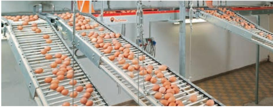
Stabförderer werden häufig als Verbindung vom Nest zur nachfolgenden Quersammlung eingesetzt. Sie sind nicht kurvengängig. Das verwendete Stabband besteht aus stabilisierten Kunststoffröhrchen, die beidseitig durch Rollgliederketten verbunden sind. Die Stababstände sind so gewählt, dass bei Steigungen oder Gefällen bis 25° auch kleinere Eier nicht durchfallen können.
