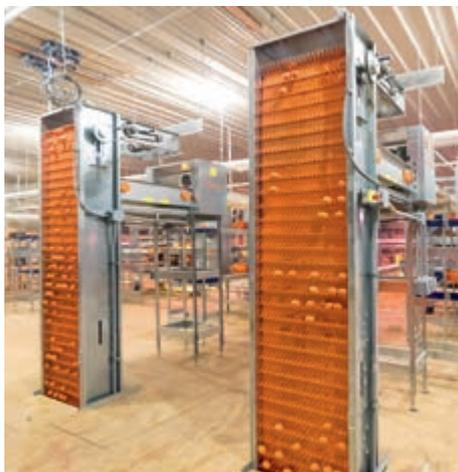
Elevator EC in einem Mehr-Ebenen-Stall
