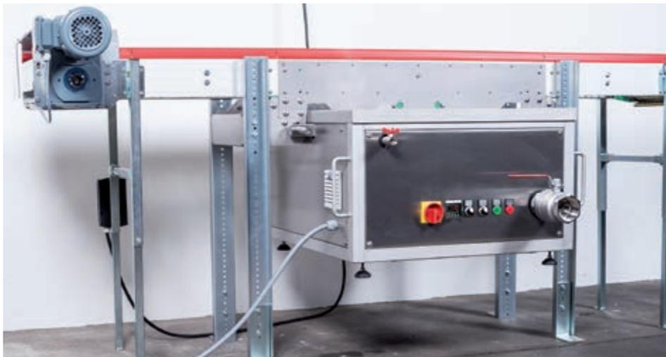
Kompakte Reinigungseinheit – benötigt weniger Platz und es ist keine Auslenkeinheit über dem Förderer nötig
