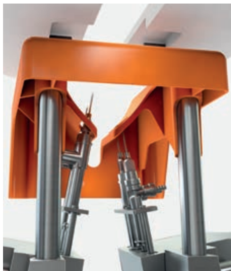
Bis zu fünf synchron arbeitende Impfnadeln reduzieren den Impfstress für die Tiere
