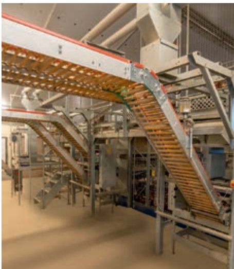
Eierlängssammlung mittels Steilförderern
