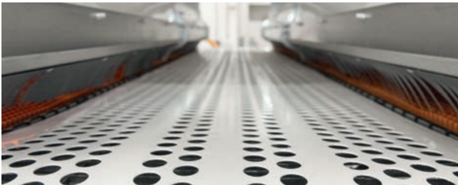
Zentrales 500 mm breites Eier-Längsband in der NATURA Step
