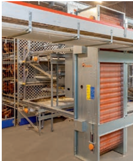
Eiersammlung mit Hilfe eines Steilförderers und automatischer Systemeiersammlung über einen Elevator
