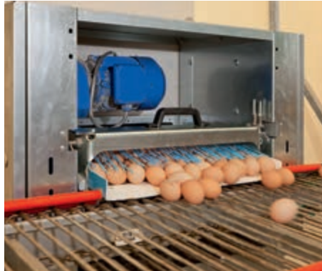
Übergabeeinheit mit Spanndrähten aus Edelstahl (optional)
