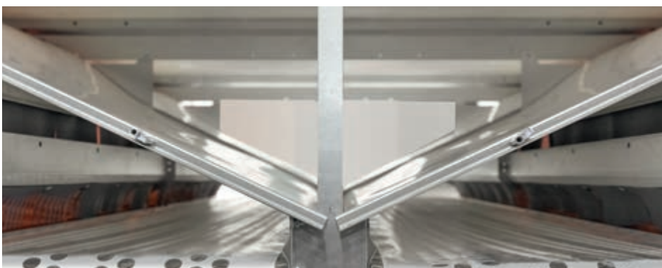
Zwei getrennte Eier-Längsbänder sorgen für einen sicheren Transport der Eier in der NATURA Step XL
