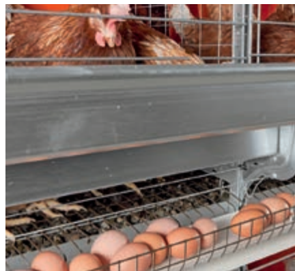
EggSaver en posición elevada → los huevos tienen el camino despejado hacia la cinta longitudinal
