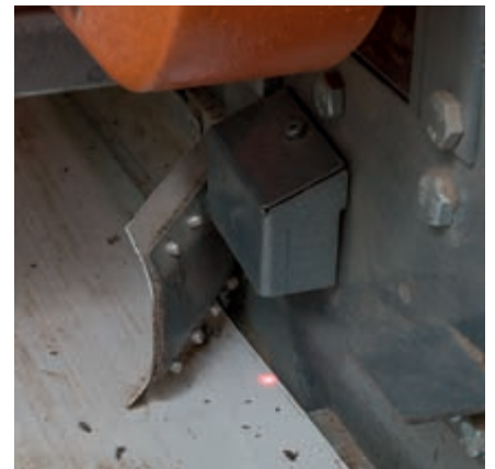
Sensor luminoso para control de cinta
