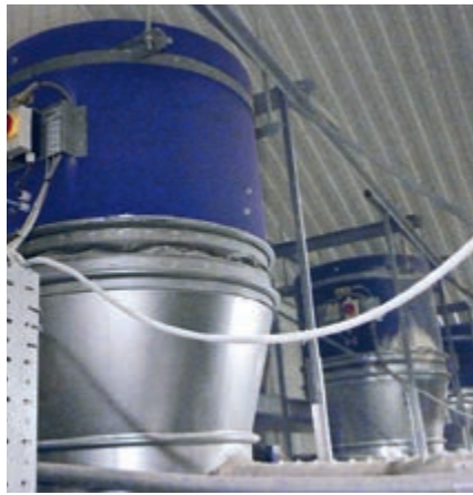
Ventilador radial R3G 400 por fila del sistema
