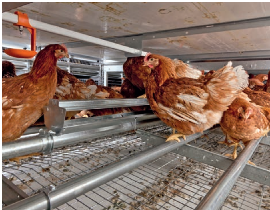
EUROVENT EU para 72 gallinas por compartimento con zona adicional de alimentación central
