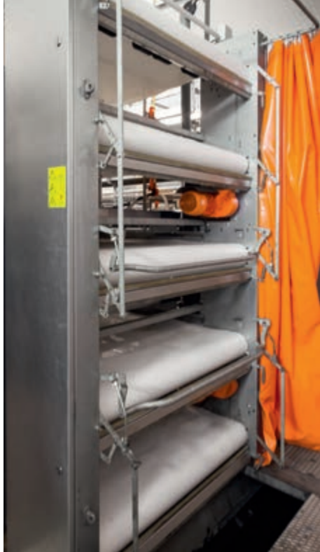
Conjunto final de cinta de estiércol con rascadores y ajuste central
