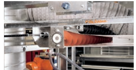
Inversión cinta de estiércol con espiral de limpieza (opcional), limpia la cinta de polvo y plumas durante el retorno
