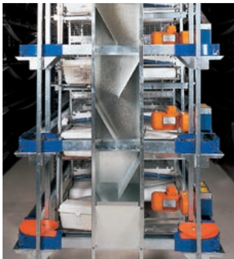
Columna de pienso en forma de cascada evita formación de puentes
