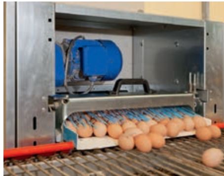
Unidad de transferencia con alambres tensados inox (opcional)
