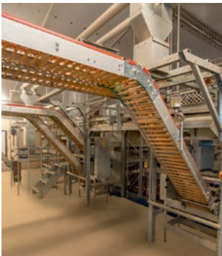
Recolección longitudinal de huevos con transportador inclinado
