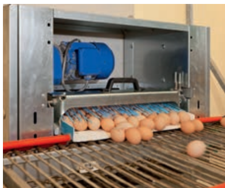
Unité de transfert avec fils de tension en acier Inox (en option)
