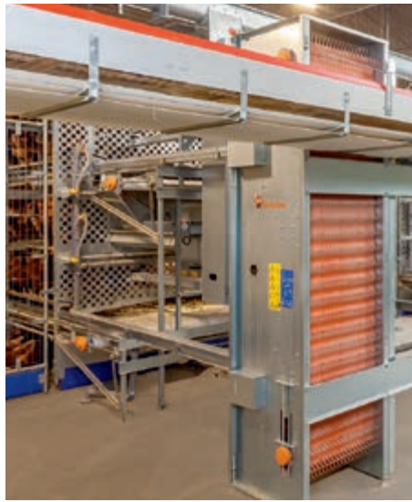
Ramassage des œufs par un convoyeur oblique et ramassage automatique d'œufs pondus hors des nids par un élévateur
