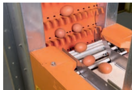
Transfert des œufs de la bande longitudinale au convoyeur à barreaux, puis jusqu'à la chaîne de l'élévateur
