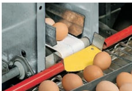
Transfert d'œufs de la bande longitudinale à la bande transversale
