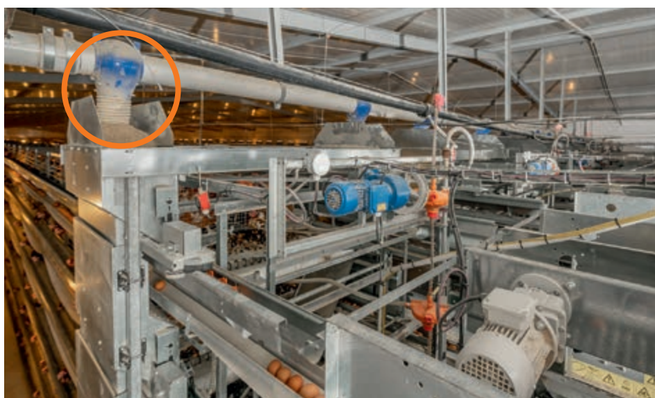
Jeu d'extrémité avant avec entraînement et système d'approvisionnement
