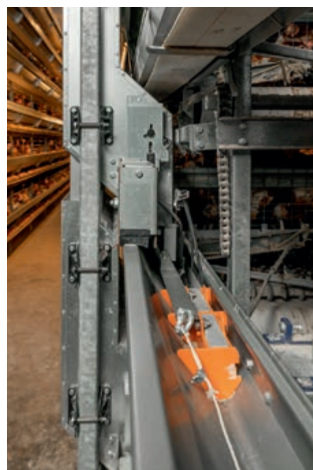
Glissière d'aliments en fin de circuit
