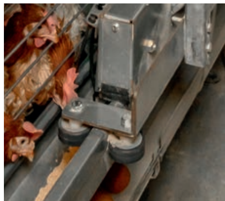
Les roues caoutchoutées montées sur un roulement à billes assurent un fonctionnement aisé et silencieux du chariot d'aliments.
