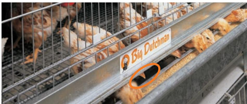
L'étage poussins avec fente d'alimentation sur la longueur. Le rebord intérieur évite le gaspillage d'aliments.
