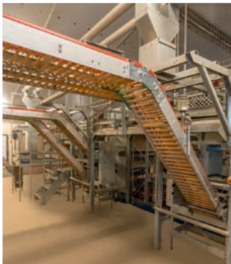
Raccolta longitudinale delle uova con trasportatori verticali
