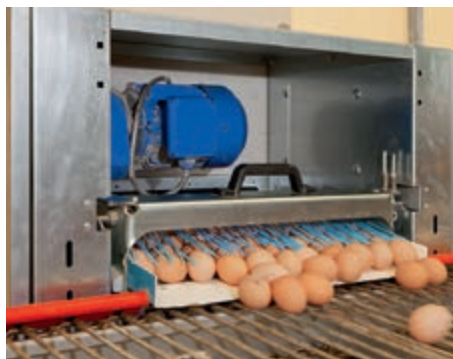
Unità di trasferimento con aste in acciaio inox a tensione regolabile (optional)
