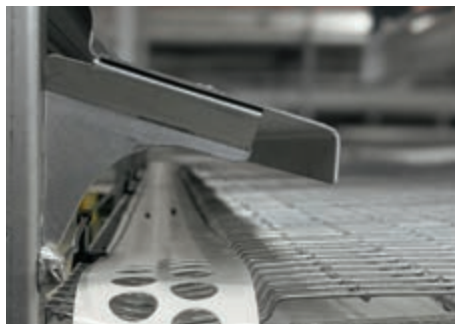
Raccolta automatica delle uova del sistema
