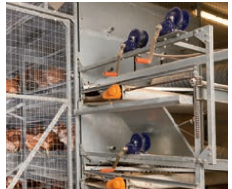
Winda ręczna na każdy poziom: równoczesne, proste otwieranie przedniej siatki
