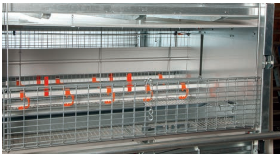
Rura grzewcza na dolnym poziomie zapewnia bezpośrednie doprowadzenie ciepła w pierwszych dniach
