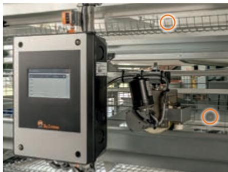
Компьютер 507 с большим дисплеем – это ключевой элемент VIM, здесь фермер может произвести все настройки напрямую, а также получает результаты.
