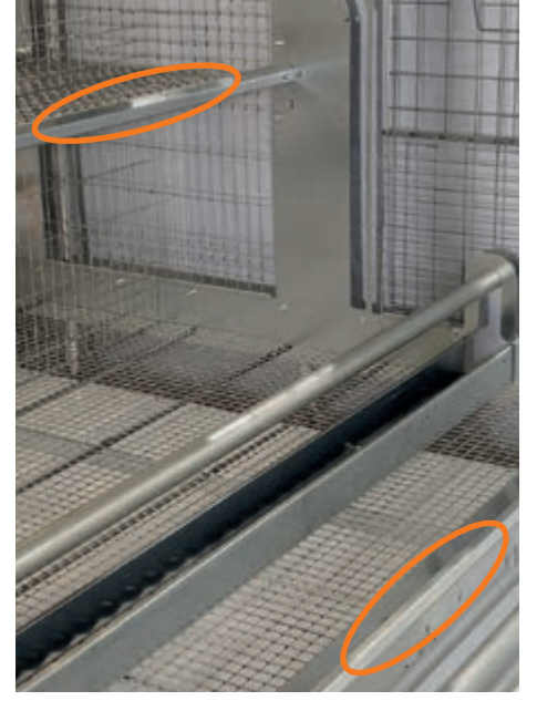
Bir bölmenin görüntüsü: her iki kattaki sac metal tüneler güvenli bir tüneme sağlar
