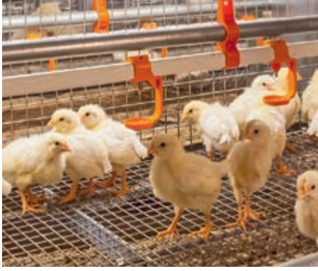
Alt ve merkez kata taban teli; \frac{3}{4} \times \frac{3}{4} inç
