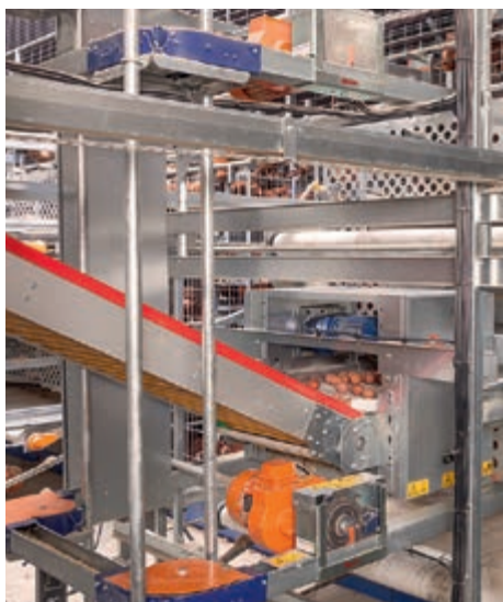
Збір яєць за допомогою вертикального конвеєра та автоматичної системи збору яєць за допомогою елеватора
