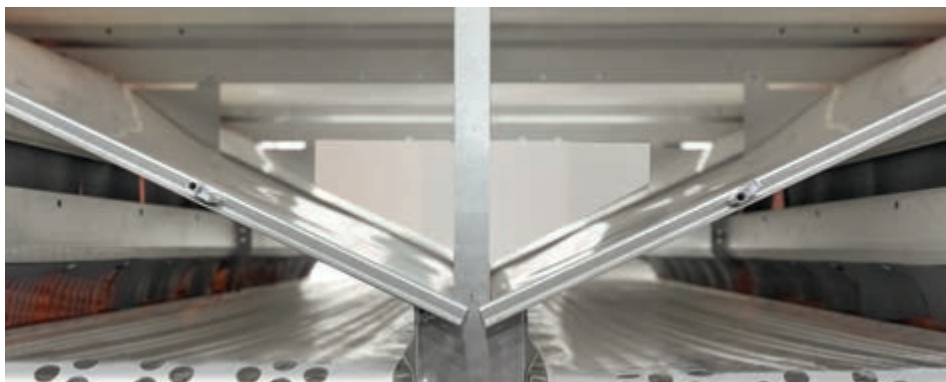
Дві окремі поздовжні стрічки для транспортування яєць забезпечують безпечне транспортування яєць у вольєрі NATURA Step XL
