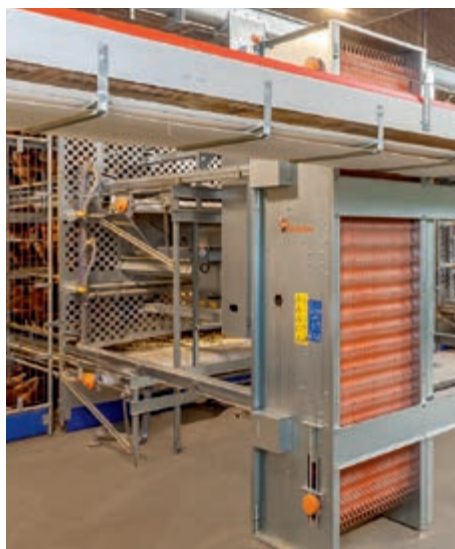
Збір яєць за допомогою вертикального конвеєра та автоматичної системи збору яєць за допомогою елеватора
