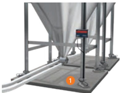
Зважування силосу за допомогою UniScale
