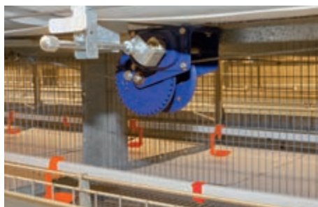
Лебідка, що змонтована по центру – для регулювання висоти лінії напування
