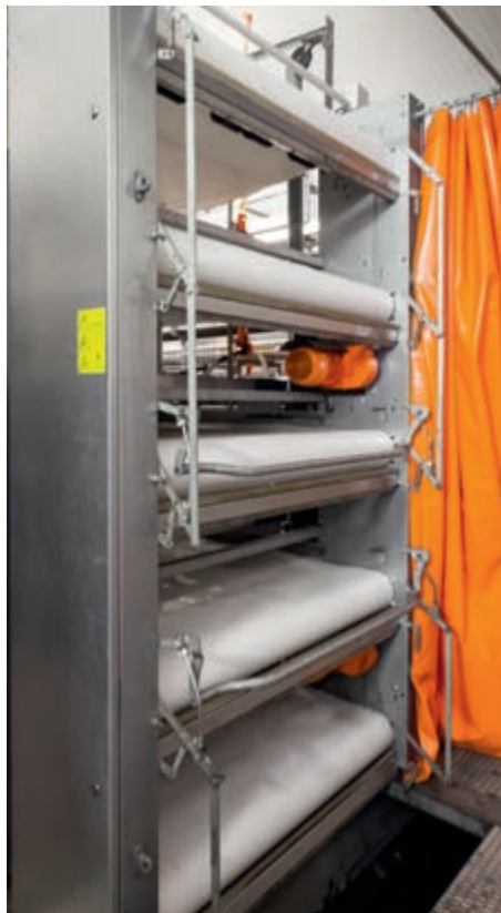
Стрічка видалення посліду зі шкребками та системою центрального регулювання
