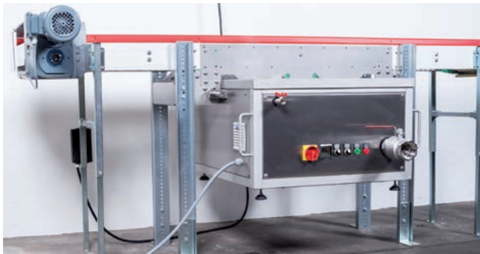
Компактний очисний пристрій: займає мало місця і не потребує пристрою відхилення над конвеєром
