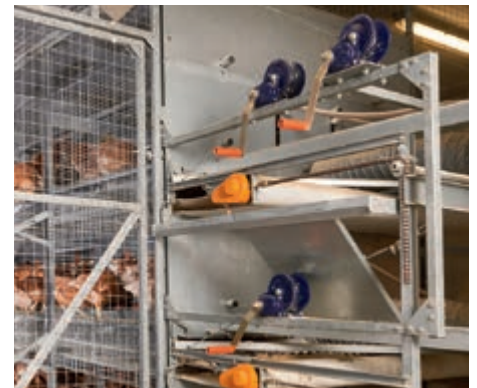
Закриття/відкриття решіток можна відкривати/ закривати одночасно та просто
