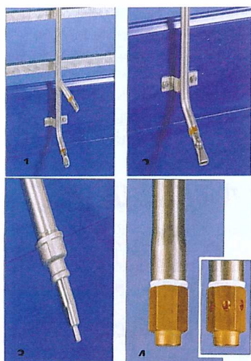
Рисунок 4- Ниппельные автопоилки фирмы «Биг Дачмен»: 1 – ниппельная поилка для откорма поросят с двумя отводами-высокое и низкое давление; 2 – ниппельная поилка для откорма поросят с шариком-высокое давление; 3 – ниппельная поилка для подсосных поросят-низкое давление; 4 – разбрызгивающая поилка для свиноматок-высокое давление.
