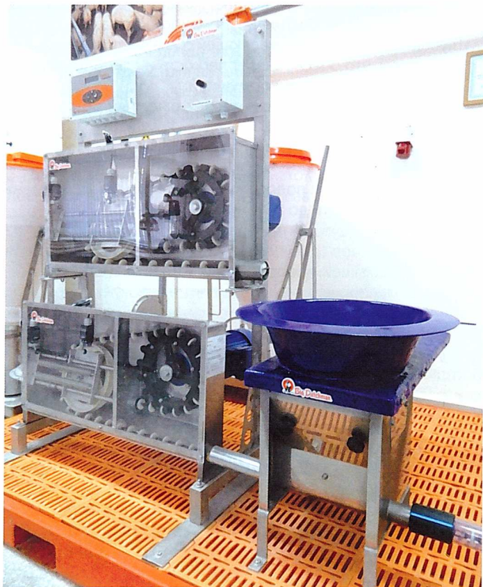
Рисунок 1 - Система кормораздачи Драй Рапид
