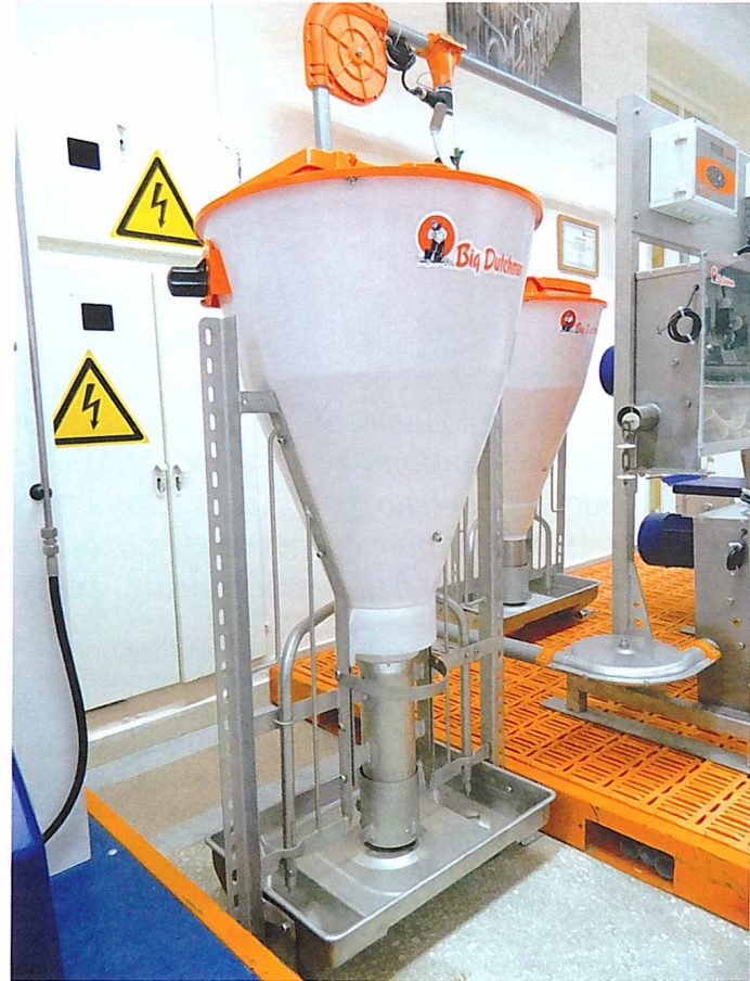
Рисунок 2- Конические самокормушки для кормления поросят-отъемышей
