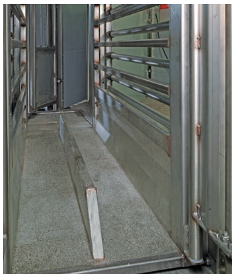
В кантара подът не позволява подхлъзване
