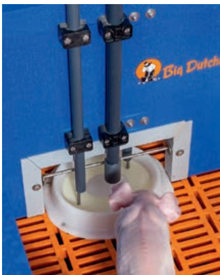
Senzor kontroluje hladinu krmiva v korytu u předává informace do 510pro
