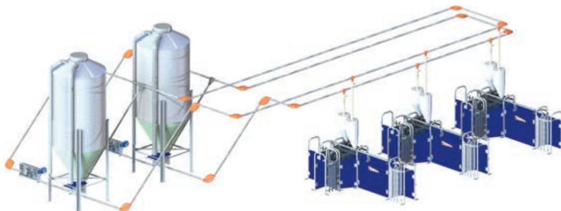
Funkční schéma CallMatic pro jako suchého krmení s použitím 2 druhů krmiva
