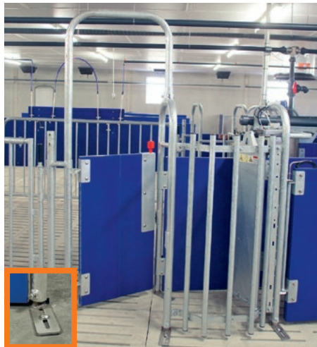
Leitständer mit schwenkbarer Tür Bodenbefestigung besteht aus Edelstahl
