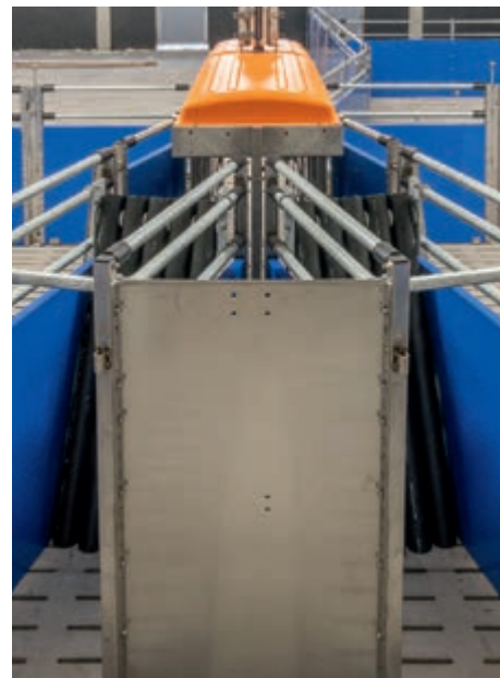
Ausgangsbereich mit zwei Selektionsausgängen
