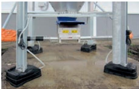
Silofußabdeckung für sichere Wiegung auch bei extremen Witterungsbedingungen
