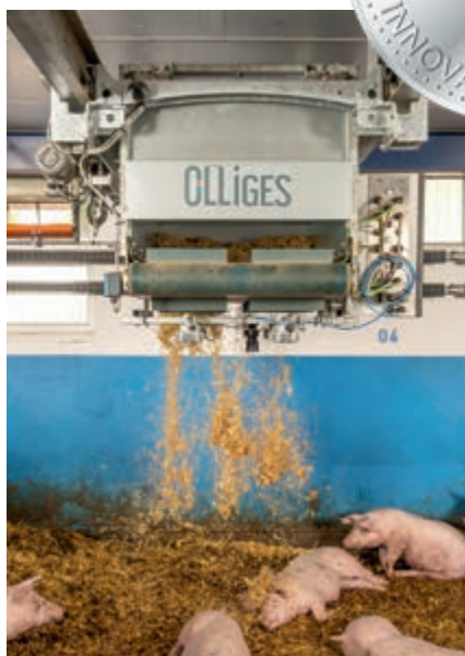
Maststall: der Einsatz des Strohroboters OlliGes verringert erheblich den Arbeitszeitaufwand für das punktgenaue und bedarfsgerechte Nachstreuen; der Roboter bewegt sich zu jeder möglichen Stelle im Stall über ein Schienensystem
