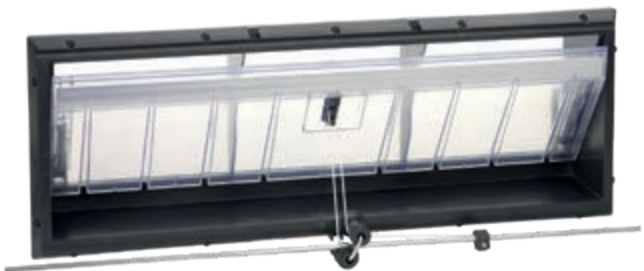
CL-3-1911/F transparente: entrada con brida desarrollada para clientes con interés en iniciativa alemana para bienestar animal (Initiative Tierwohl). La superficie transparente de la ventana debe abarcar al menos el 3 % de la superficie del suelo de la sala. Aquí se dispone de 0,14 m 2 de superficie transparente por cada entrada de aire.
