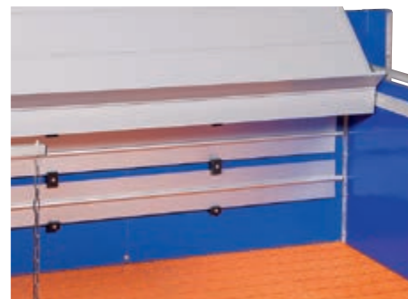
Tubos Twin aportan temperatura ideal en área de descanso de lechones; rejilla plástica con solo 10 % de perforación
