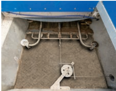
Pala desplazadora para retirar excrementos
